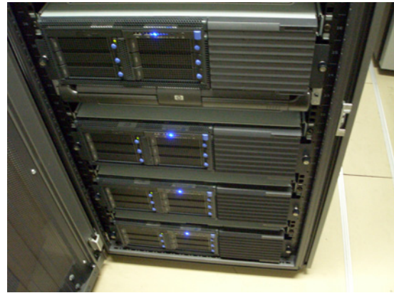
図3 InfiniBand スイッチ MTS2400 DDR で接続された Opteron クラスタ IBQ Fig. 3 Opteron Cluster IBQ, connected with InfiniBand switch MTS2400 DDR.
