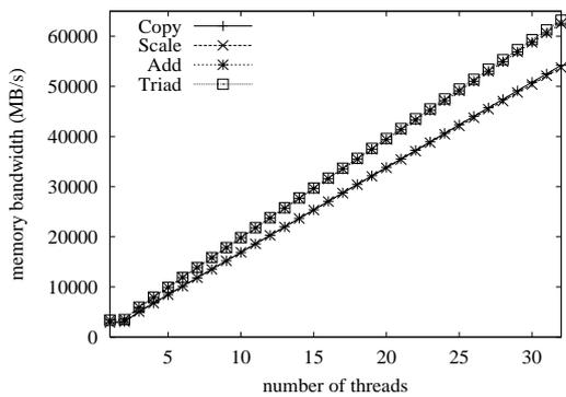
図 12 SGI Altix 上 (配列サイズ 80,000,000) での STREAM benchmark の性能 (MB/s)
