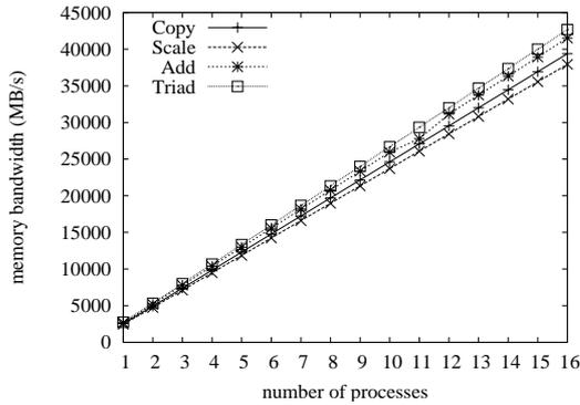
図 11 ノード当たり 2MPI プロセスで実行した場合の STREAM benchmark の台数効果
