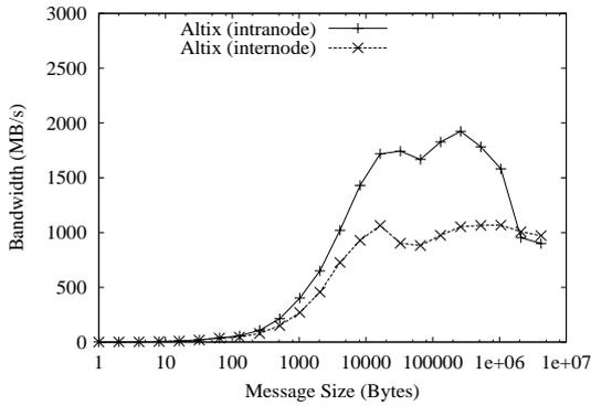
図 10 SGI Altix 3700 上での双方向帯域幅。
